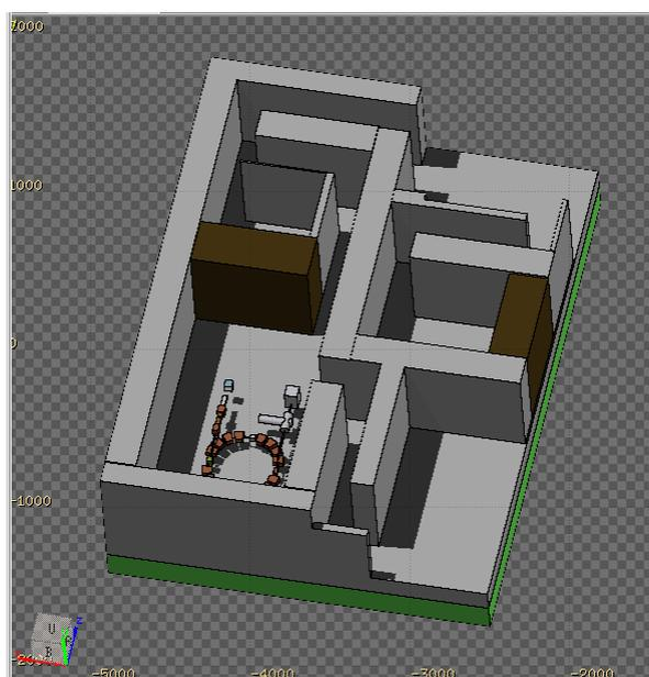
图 5-1 质子治疗系统屏蔽模拟计算模型图
